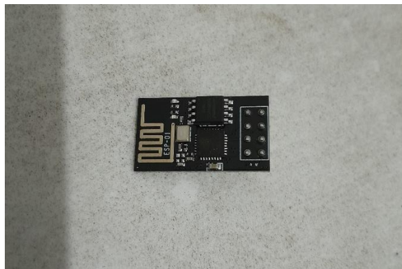
Gambar 5. Modul Wi-Fi ESP-01
